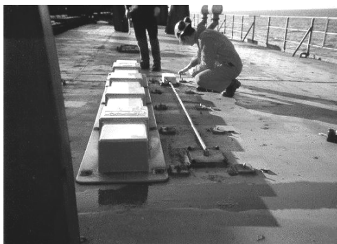
Рис. 4.16. Тензодатчик с длинной основой, устанавливаемый на палубе балкера
