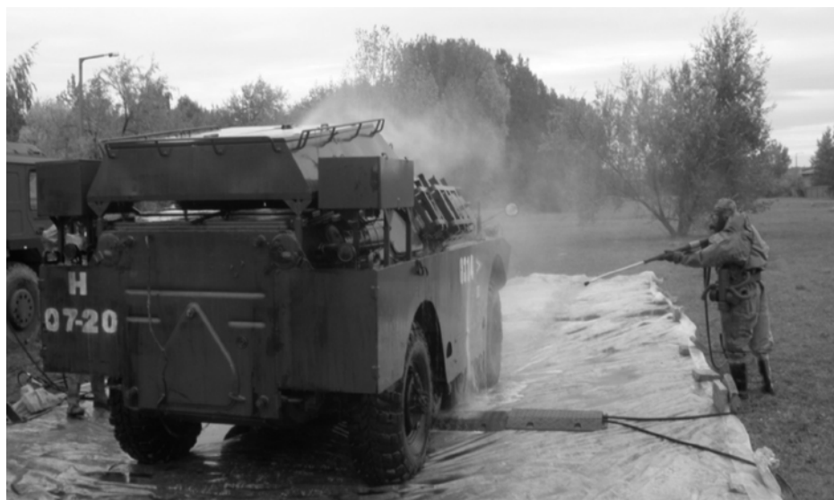
Рис. 22. Дезактивація транспортного засобу гарячою водою під високим тиском
