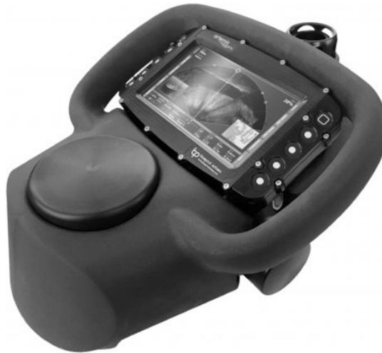
Рис. 18. Фото підводного сонару кутового огляду [4]
