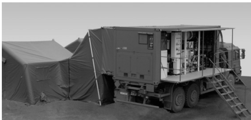
Рис. 23. Дезактивація людей системою DECOCONTAIN 3000 GDS
