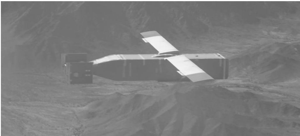
Рис. 33. Фото вантажного безпілотного літального апарату одноразового використання [8]
