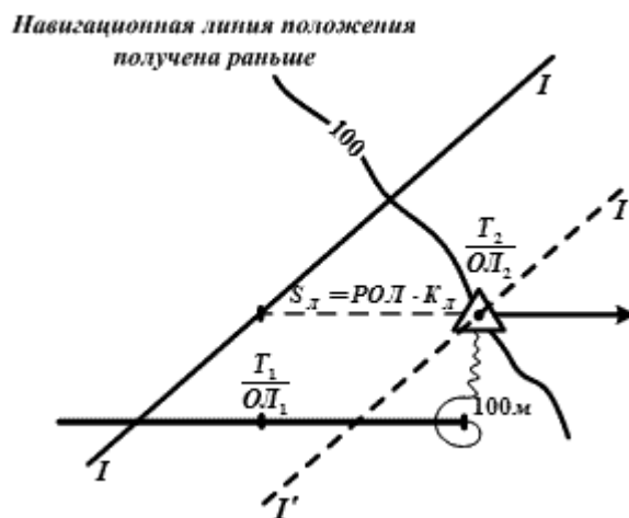
Рис. 15.5. Определение места судна по навигационной линии положения и глубине, измеренных разновременно
