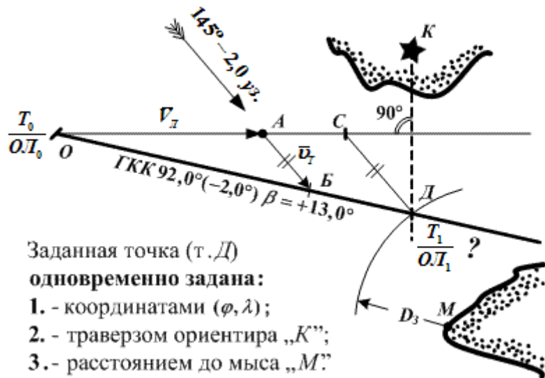
Рис. 8.13. Предвычисление времени и отсчета лага прихода судна в заданную точку при учете течения
