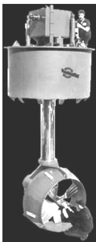
Рис. 5.12. Вытягивающееся азимутальное ПРУ.
