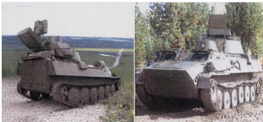
Рисунок 27 – Радіолокаційна станція розвідки рухомих наземних та надводних цілей 1РЛ 232 – 2М “СНАР – 10 М1”.
