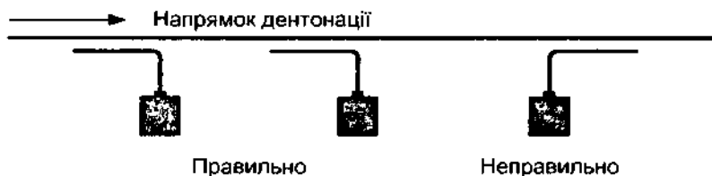
Рис. 13.7. Розміщення зростків у мережах детонуючого шнура залежно від напрямку детонації
