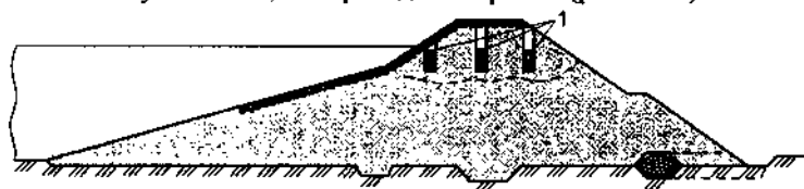
Рис. 24.3. Підривання земляної греблі без діафрагми: 1 – заряду в колодязях.
