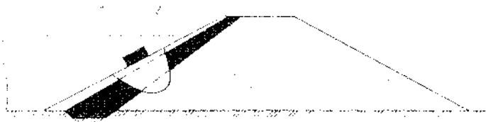
Рис. 24.5. Підривання земляної греблі з пластичним екраном:
