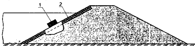
Рис. 24.4. Підривання земляної греблі з жорстким екраном: 1 – заряд, 2 – жорсткий екран.
