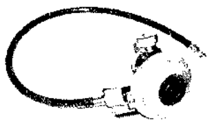
Рис. 6.18. Загальний вигляд легеневого автомата
