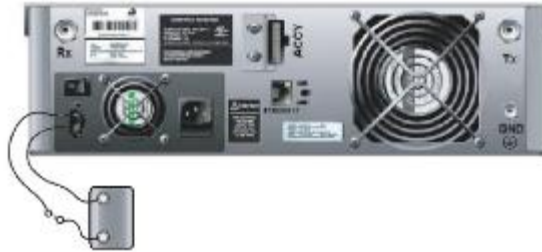
Рисунок 2.8.16 – підключення резервного акумулятора до ретранслятора DR 3000.
