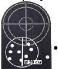
Рисунок 2.4.6 – порядок визначення купчастості.
