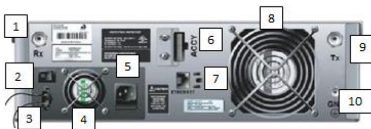
Рисунок 2.8.15 – зворотня панель ретранслятора DR 3000.
