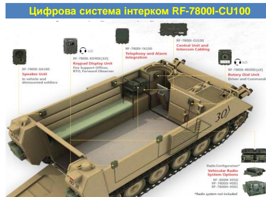
Рисунок 2.8.38 – склад цифрової системи інтерком RF-7800I - CU100.
