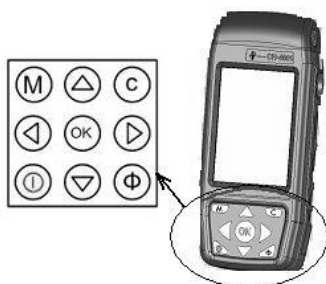
Рисунок 2.9.9 – вигляд приймача НАС та схема клавiш керування.
