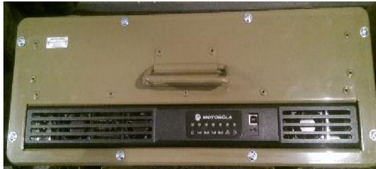
Рисунок 2.8.22 – ліцева панель ретранслятора “Либідь К-2РТД”.
