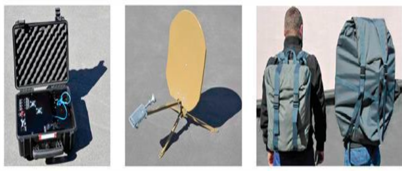
Рисунку 2.8.50 – мобільний комплект супутникового зв'язку 1.1. (МКСС 1.1).
