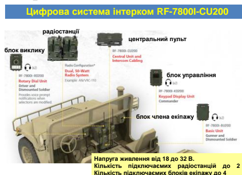
Рисунок 2.8.39 – склад цифрової системи інтерком RF-7800I – CU200.
