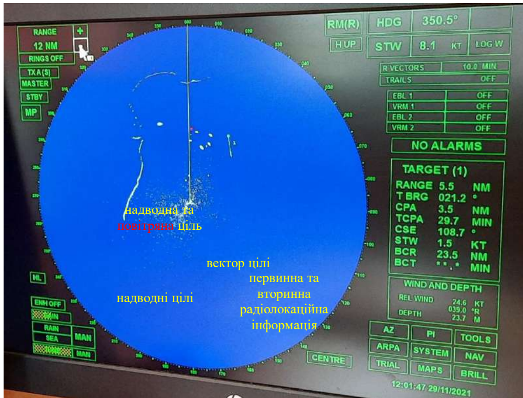
Рис.3. Вибір оптимальних режимів роботи корабельних РЛС на прикладі станції Bridge Master E; спостереження та захват на супроводження цілей
