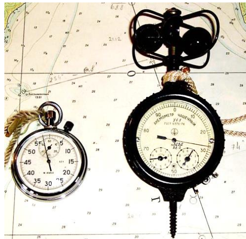
Рис. 13.7 – Ручний анемометр (праворуч) і секундомір.
